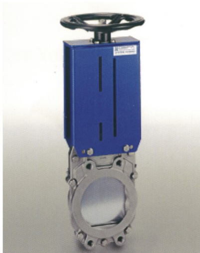
达米诺(Domino) AT150 不锈钢刀闸阀 法兰标准: DIN EN1092-1 总长标准: EN 558-1 DIN3202-K1 尺寸: DN50~DN150: PN10/16 DN200-DN300: PN10
